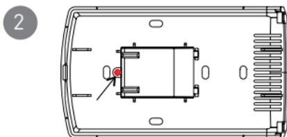
2 Aprire l'involucro del relè con l'uso di un cacciavite
