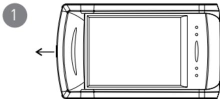
1 Aprire il dispositivo con un cacciavite e rimuovere la parte frontale
