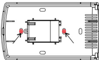
Fissare a parete il termostato utilizzando le viti in dotazione
