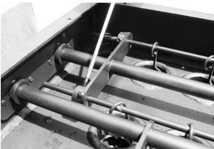
L'operazione può essere completata svitando con un cacciavite la parete della caldaia e estraendo tutte le giunzioni orizzontali.
