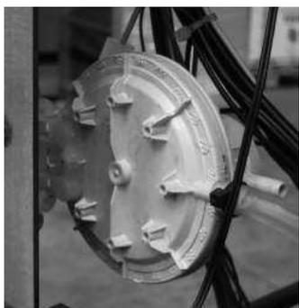
**Pressostato fumi:** controlla la pressione nel condotto fumario. Esso provvede a bloccare la coclea di caricamento pellet nel caso lo scarico sia ostruito o ci siano contropressioni significative ad esempio in caso di presenza di vento, di porta della camera di combustione aperta o guasto dell'estrattore fumi. Nel momento di intervento del pressostato apparirà la scritta **"ALAR-DEP-FAIL"**.
