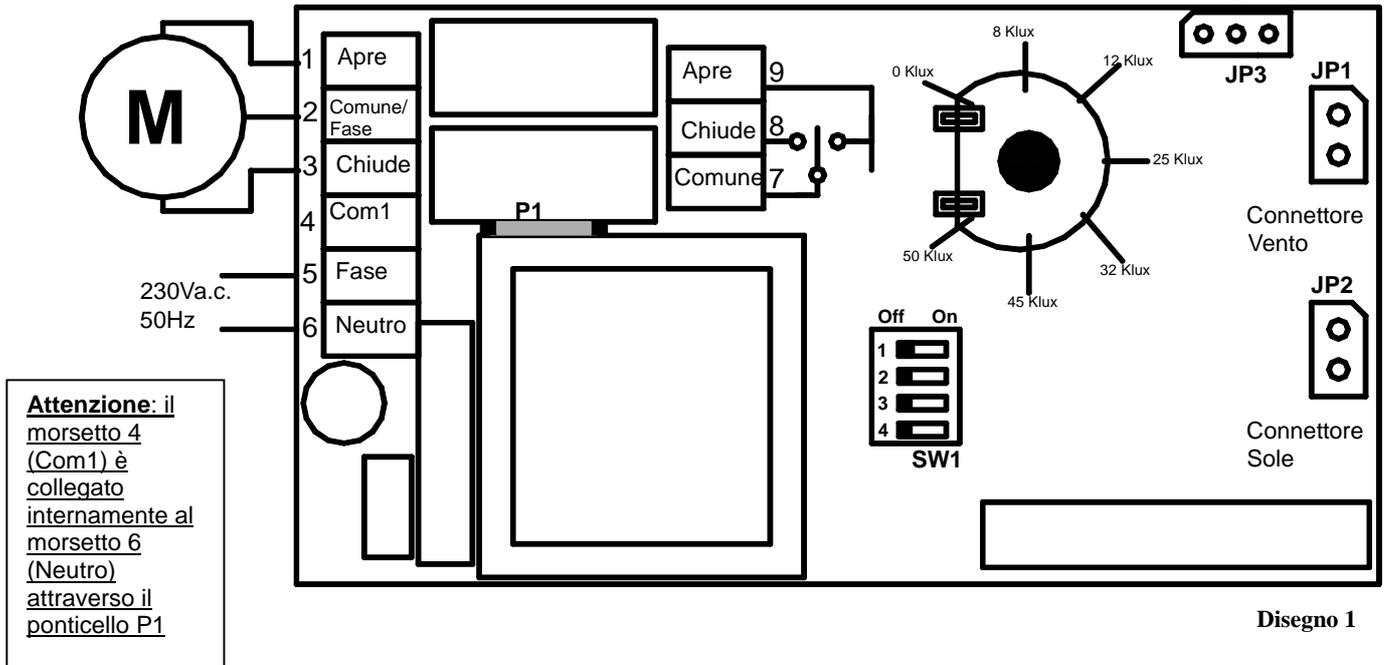
**Attenzione:** il morsetto 4 (Com1) è collegato internamente al morsetto 6 (Neutro) attraverso il ponticello P1
