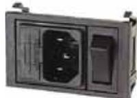
Collegare il cavo di alimentazione prima sul retro della stufa e poi ad una presa di corrente a parete accessibile. L'interruttore in figura I/O deve essere posizionato su I per alimentare la stufa. In caso di mancata alimentazione controllare lo stato del fusibile posto nel cassetto sotto l'interruttore (fusibile da 4A). Nel periodo di inutilizzo è consigliabile togliere il cavo di alimentazione della stufa.
