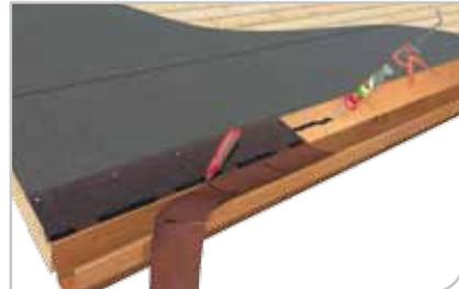
L'installazione può essere eseguita solo su tavolato di legno (spessore > 24 mm). Per pendenze inferiori al 35% si raccomanda di installare precedentemente uno strato di protezione. Preparare la prima fila tagliando longitudinalmente le faldine delle tegole.
