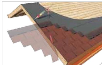
Dove necessario rifilare lateralmente le tegole. Al termine controllare l'incollaggio e utilizzare il mastice bituminoso BARDOSTICK per rinforzare il fissaggio.
