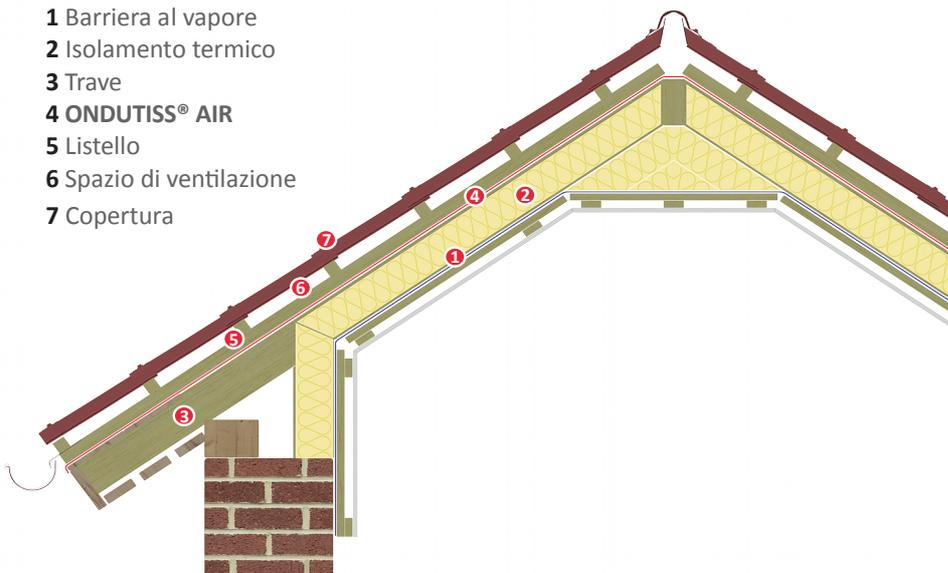
Srotolare ONDUTISS® AIR partendo dal basso e parallelamente alla linea di gronda, con la scritta rivolta sempre verso l'alto. La membrana può essere posata direttamente sull'isolamento termico. La sovrapposizione corretta è indicata da linee o dalla stampa del logo. Per una migliore tenuta all'acqua sigillare le sormonte di ONDUTISS® AIR con il nastro adesivo ONDUTISS® UNO.
