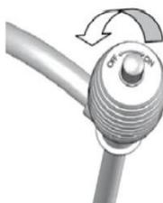
Finito di riempire il serbatoio della stufa (una volta raggiunto il livello MAX segnalato con una riga), posizionare la manopola sulla posizione off, ruotando la stessa in senso antiorario. In questo modo si svuota la pompa a sifone.
