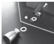
Inserire i componenti come nella figura, facendo entrare le vite per la parte concave del magnete
