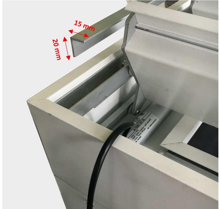
Tra la prima e la seconda dogha, con una punta da 3,5 mm forare profilo a U + angolare + primo strato del profilo grondaia, successivamente avvitare i tre profili con una vite **ICONA 10**.
