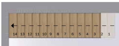
misure di riferimento per il foro solaio
