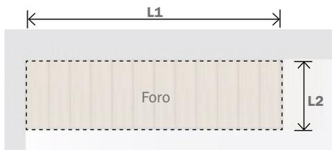
misure di riferimento per il foro solaio
